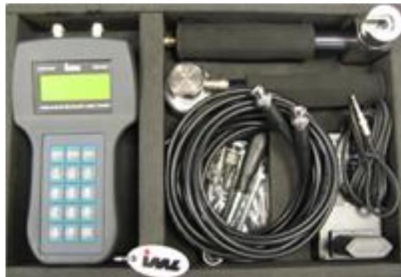
**Résistographe F 400 ou F 300** : matériel spécialement adapté aux calculs des seuils de rupture des bois, et d'établissement de cartographie de cavité par pénétration d'une mèche dans le bois donnant l'épaisseur de matière non altérée. Les résultats commentés sont joints dans le rapport ou en annexe. Les valeurs obtenues sont ramenées aux seuils.
